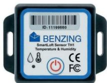
Der BENZING Smart Loft Sensor TH1 ist ein batteriebetriebener Bluetooth-Sensor zur Überwachung von Temperatur und Luftfeuchtigkeit im Taubenschlag. Er zeichnet Werte im Bereich von -25°C bis +60°C auf, die auf dem BENZING Smart Loft Dashboard angezeigt werden können. Sie können bis zu 10 Sensoren gleichzeitig mit dem BENZING Live Smart Hub 5 verwenden.
