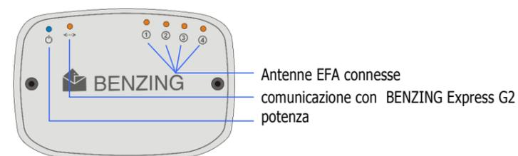
dopo essere stata attaccato alla corrente, BENZING Antenna Controller, controlla le antenne EFA.. Il BENZING Express G2 connesso, controlla le antenne per i piccioni e legge le informazioni dagli anellini. la potenza per il BENZING Express G2 è fornita dal BENZING Antenna Controller. le informazioni sullo stato del BENZING Antenna Controller sono mostrate dalle luci in cima al controller.
