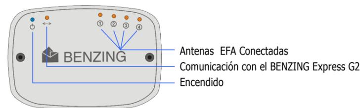
Después de la conexión principal, el controlador BENZING de las antenas verifica las antenas EFA conectadas. La conexión del BENZING Express G2 verifica las antenas para los anillos de las palomas y lee la información del anillo. El encendido para el BENZING Express G2 se proporciona por el controlador BENZING de las antenas. La información del estado del controlador BENZING de las antenas es mostrada por las luces en la superficie del controlador.
